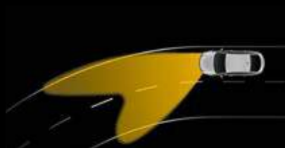
2. Dans un virage. Les phares avant pivotent jusqu'à 15° le temps du virage. Activés par l'angle de braquage et la vitesse du véhicule.
