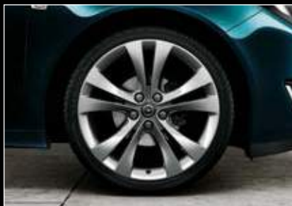
Jante alliage, 8,5 J x 20", 5 branches doubles, avec finition laquée multi-couches haut de gamme, pneus 245/35 R 20 (RTH).
