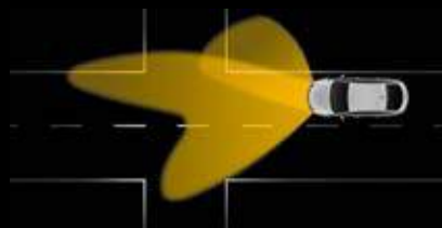
1. Dans une intersection. Éclaire à 90° vers la gauche ou la droite afin que vous disposiez d'une meilleure visibilité dans les virages.
